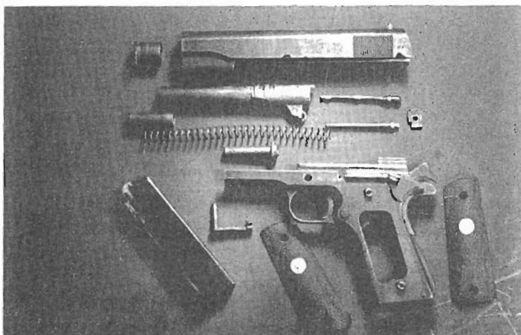
Despiece de una pistola semiautomática
