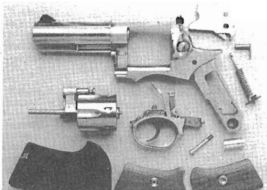
Despiece de un revólver
