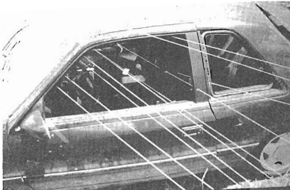
Acercamiento de las trayectorias de los proyectiles
