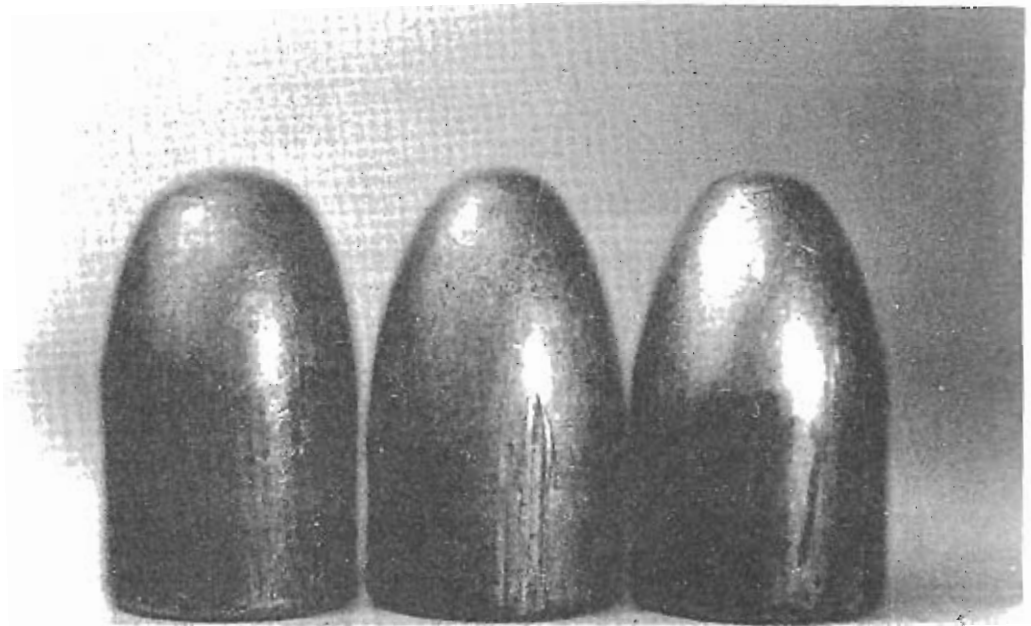
Orientación del rayado en los proyectiles
