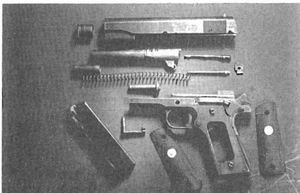
Despiece de una pistola semiautomática
